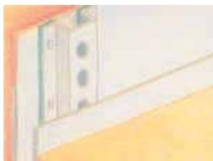
*Sigillatura di profili rivettati con Ködiplast CS*
