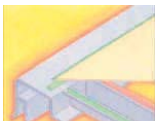
Assemblaggio di profili del tetto con Körapop 235
